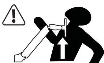
**NL** WAARSCHUWING! Gevaar door opgeslagen energie: het hefmechanisme van het werkoppervlak staat onder spanning en verplaatst zich zelfstandig snel omhoog wanneer de bevestigde apparatuur wordt verwijderd. Verwijder apparatuur daarom ALLEEN nadat de arm in de hoogste stand is gezet! Als u deze instructie niet opvolgt, kan dit tot ernstig persoonlijk letsel en/of beschadiging van de apparatuur leiden!
