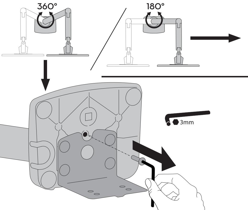
Hoe de schroeven om het draaien te stoppen te vervangen (Armen moeten zich in een opwaartse positie bevinden)
