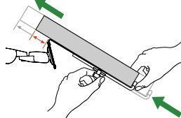
Para lograr una instalación equilibrada, quizás deban colocar muy atrás en la bandeja los portátiles de mayor tamaño, o bien aquellos con plataformas de fijación/duplicadores de puertos.
