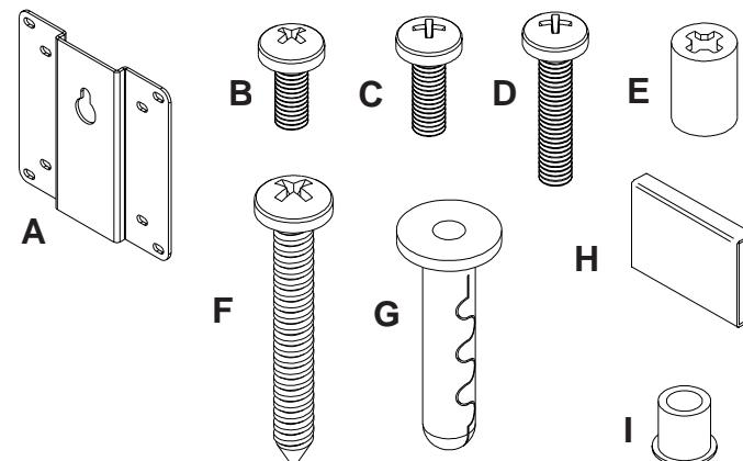
**1** Ce produit est conçu pour les moniteurs à cristaux liquides qui disposent de la disposition de montage Vesa®. Afin de garantir une installation sûre, assurez-vous que les vis aient un engagement d'au moins trois tours dans les trous piriformes de montage de l'écran.
